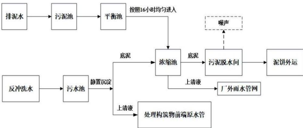
图 4 项目污泥、工艺废水处理工艺流程简述
