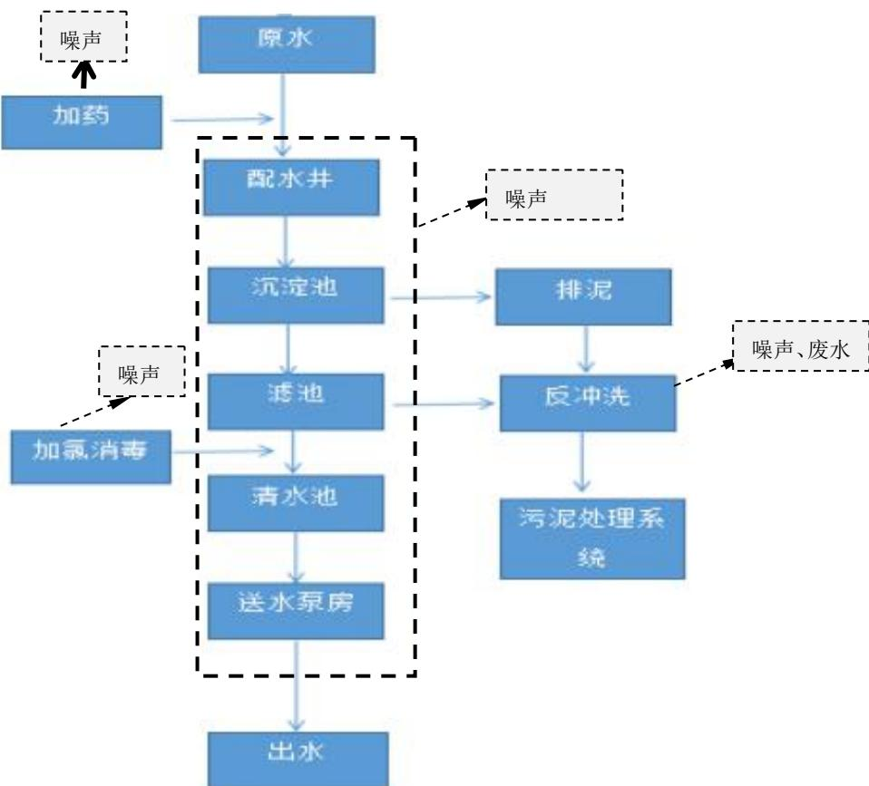
图 3 项目运营期净水处理工艺流程示意图
