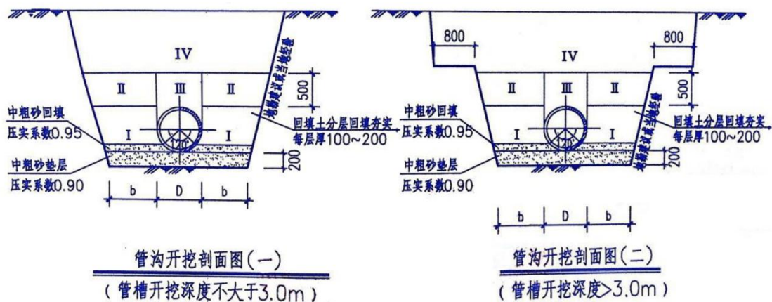
图 1 管沟开挖剖面图
