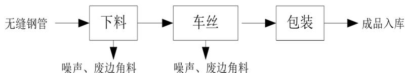
**图 1 项目生产工艺流程及产污环节**
